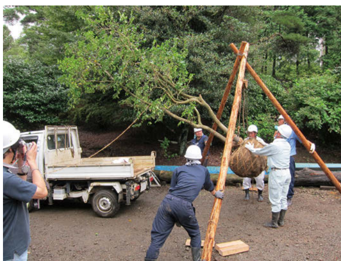
三又を使って樹木を軽トラックに積み込む
