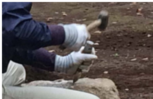
たがねとセットウで石を割る作業
