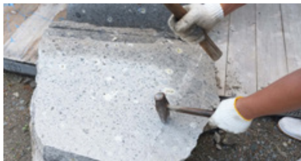
石材の割る部分にコヤスケの刃を当てて、セットウで叩いて石を割る
